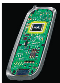
Bild 2 | Im Gegensatz zu anderen derzeit verfügbaren, aus zwei Kernen (DSP + MCU) bestehenden Prozessor-Controller-Kombinationen, z.B. für Handys, kommt die „MXC Communication Engine“ mit nur einem für diesen Zweck optimierten StarCore-DSP aus.
