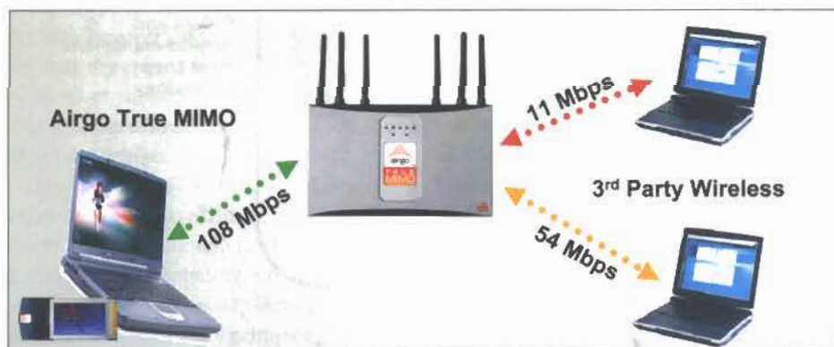
Figur 2. I den første fase - som man nu for alvor er trådt ind i - vil man se teknologien blive introduceret i 'retail-produkter' som 802.11a/b/g WLAN-routere, der vil kunne arbejde med datahastigheder på over 100 Mbit/s. Dette er selvfølgelig under forudsætning af, at der også er MIMO-chipsæt på receiversiden. Men som illustreret på figuren er der fuld 802.11a/b/g kompatibilitet, så en MIMO-baseret router selvfølgelig vil fungere sammen med udstyr, hvor der er integreret 802.11a/b/g kommunikationsnitflade.
